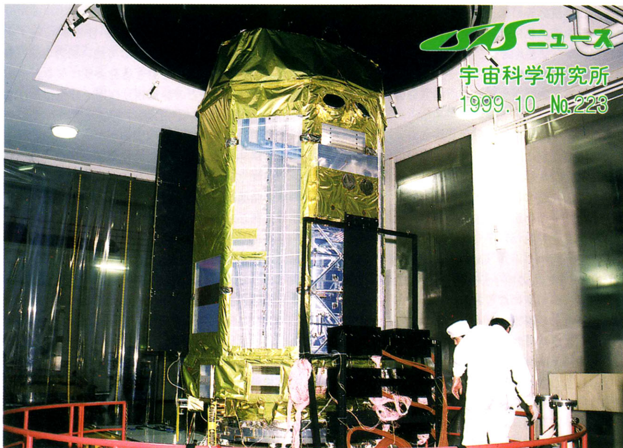
▲ASTRO-E熱真空試験（本文記事参照） 撮影：新倉克比古
