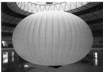
【写真1】室内での展張・加圧試験。直径20mの大きさに悪戦苦闘。
