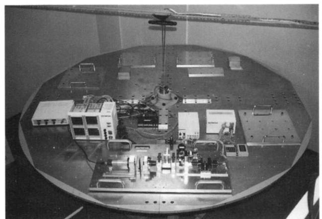
図 1 宇宙研内の遠心加速器 (最大遠心力：20G)
