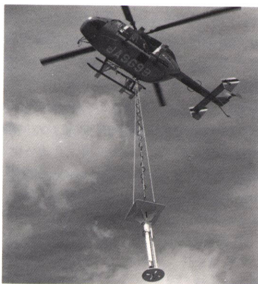
写真1 ヘリコプタで吊り上げられるペネトレータゴンドラ (空中発射装置)。
