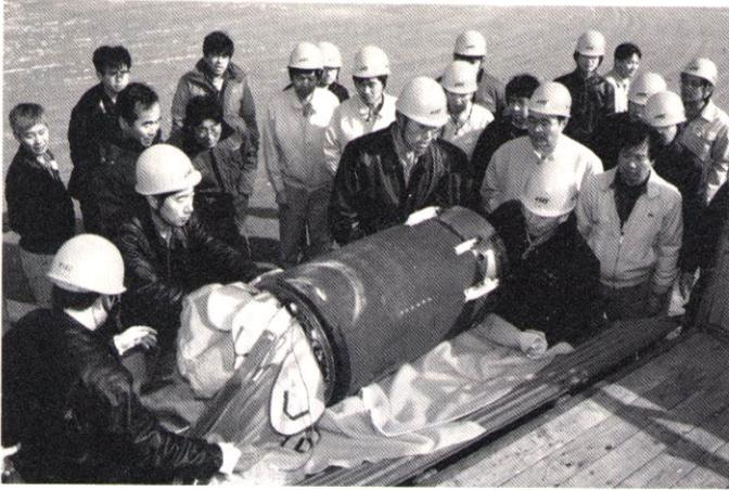
研究に欠かせない観測対象であり、観測には大きな期待がかけられていた。この実験は昨年度行われる予定であったが、打ち上げ前の噛み合わせ試験の段階で、振動、衝撃による<sup>3</sup>He冷凍機の温度上昇が懸念されたためやむなく実験の延期を決めたもので、昨年一年間改良を加え、今年度再挑戦したものである。
