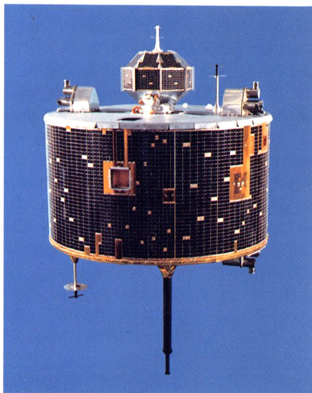
衛星「ひてん」の外観、上部に孫衛星「はごろも」が組み付けられている
