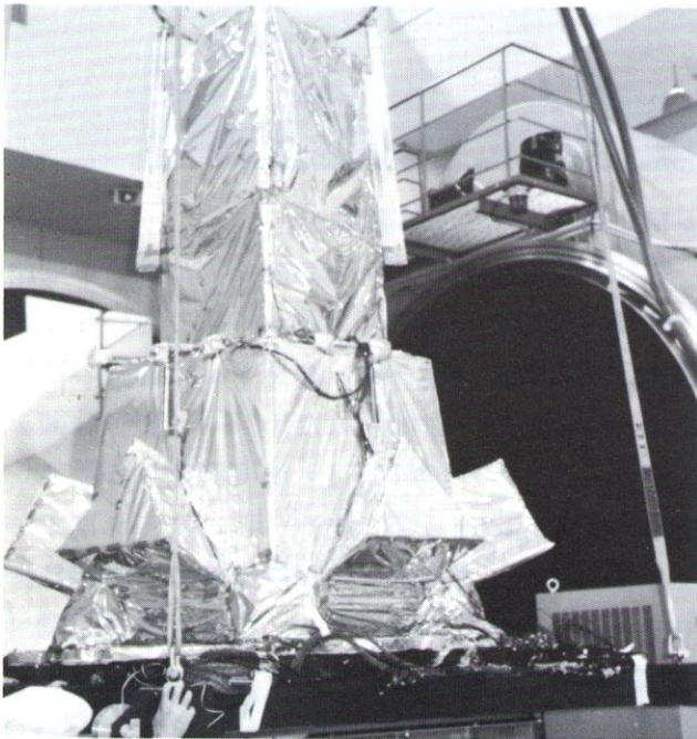
大型展開アンテナ熱モデル試験
