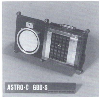
図4 「ぎんが」に搭載されたガンマ線バースト検出器比例計数管と無機シンチレータ検出器、重量3kg
