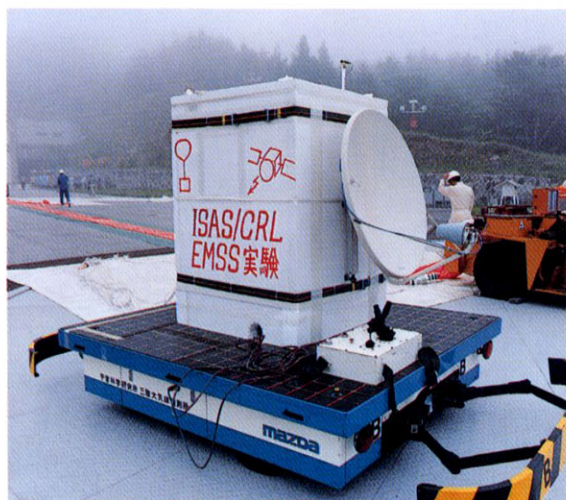
▲ 衛星リンク気球実験のゴンドラ。このパラボラアンテナで静止軌道上の衛星と通信する。
