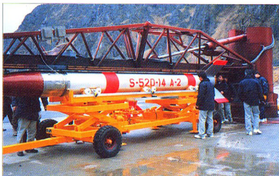
ロケットのランチャ組み付け作業
