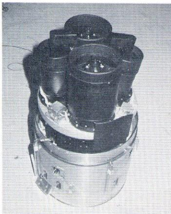
鏡17cm)を用い、CsIを塗ったMCP(マイクロチャンネルプレート)を使って、紫外域(有効波長150nm)での乙女座銀河団の二次元撮像を行いました。他の二本は望遠鏡のアスペクトを兼ねた9cmの望遠鏡で、波長160-320nmの範囲で、恒星及び背景輻射の測光を行いました。姿勢制御付で、しかも観測側からの要求精度の高い実験ということで、各方面にわたり気をもむことの多い実験でしたが、搭載機器担当者は連夜の高歌放吟で英気を養いつつ、無事のりきりました。(尾中 敬)
