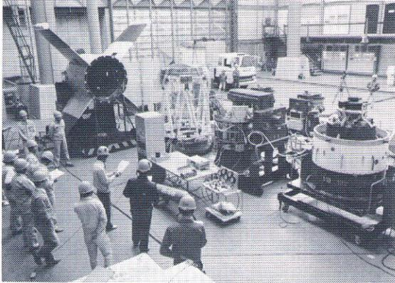
制御系総合チェック、16日にはランチャの動作を含む地上系の一斉チェックそれぞれ問題なく終えた。また、この間平行して、サブブースタ、第1段、第2段のそれぞれノズル部、サブブースタ頭部の組立、尾翼筒の組付けが行われ、12月の組立オペレーションへと送られた。(小野田淳次郎)
