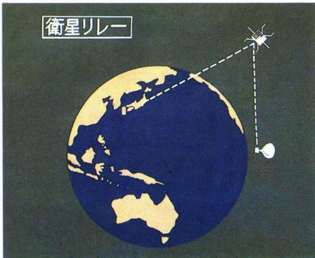
衛星を気球の中継に用いる
