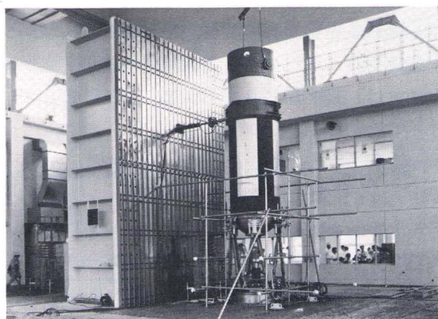
構造機能試験棟での1・2段接手部破壊試験 (相模原)
