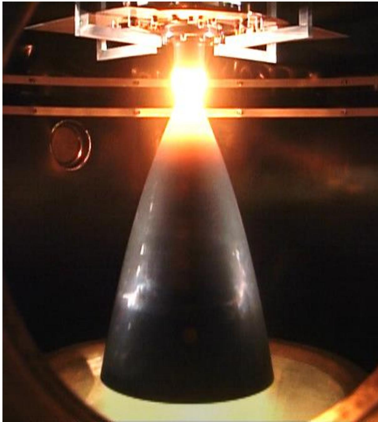
燃焼試験中のセラミックスラスタ
