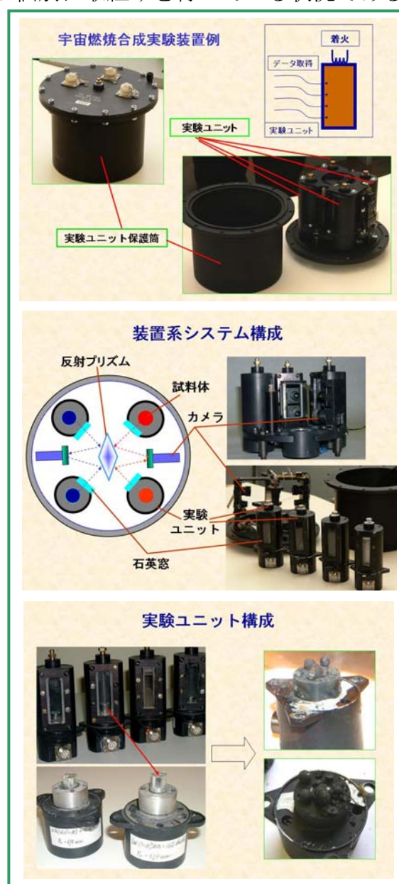
図 3 宇宙燃焼合成実験用装置例 (ロシア ISMAN 研究所)
