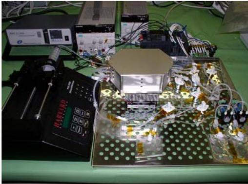
図 4. 自動培養システム試作機
