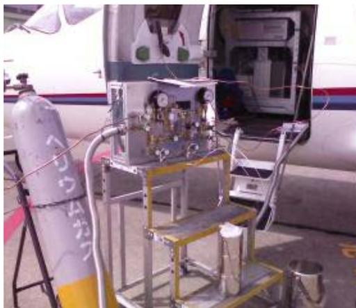
エプロンに待機中のMU300とヘリウムガスのコンデンスのためのGHS。
