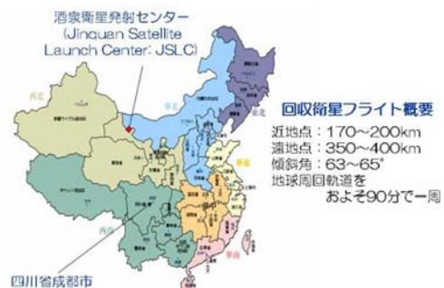
中国側からの情報によれば、回収衛星は近地点 170~200km・遠地点 350~400km、傾斜角 63~65° の地球周回軌道をおよそ 90 分に一回の割合で周回し、15 日後の 9 月 24 日 10 時 30 分に四川省の砂漠にて回収された。回収されたサンプルは直ちに航空機により北京へ輸送される予定であった
