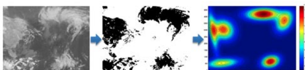
図4 多変量正規分布による雲塊のモデリング。左から原画像，2値化画像，混合分布によるモデリング結果 [8]
