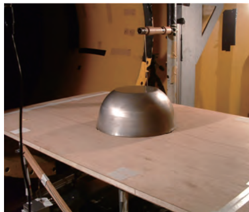
図3 火星表面を想定した風洞試験
