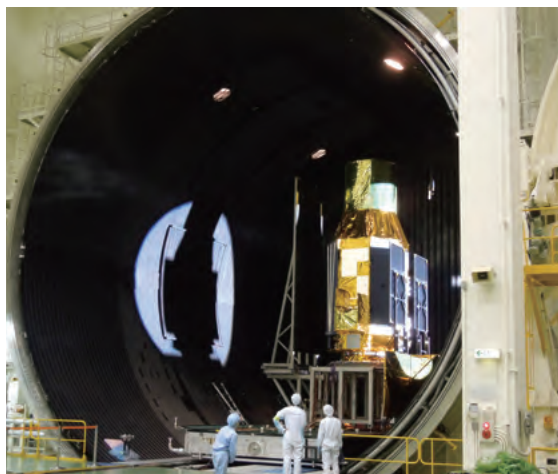
衛星システム試験のひとつ。13mφチャンバーでソーラー光照射チェックを行っているところ。チャンバー内壁に映ったシルエットを見ると、6mφの光束では望遠鏡はみ出ているのが分かる。
