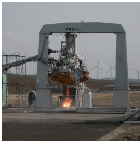
移管後、最初の燃焼試験となった、高頻度再使用ロケット実験機(FRV-1)の燃焼試験の様子。
