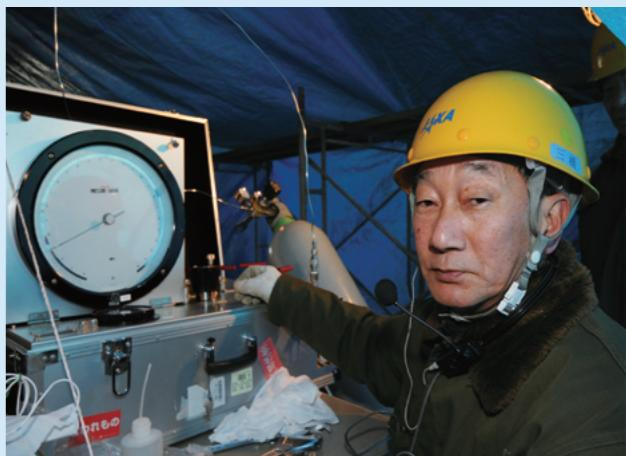
現在行われているFRV（高頻度再使用ロケット実験機）燃焼試験の準備風景。大気燃焼棟、圧力の校正作業の一ひとこま。
