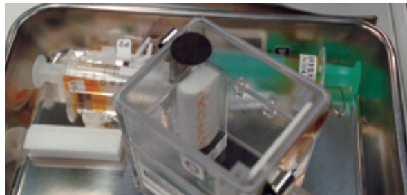
軌道上実験で使用されたものと同じ培養チャンバーと給水用の注射器。スポンジに刺さっているのがキュウリの種子。
