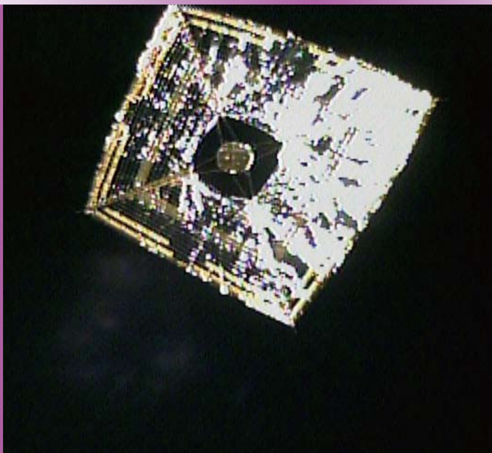
分離カメラが撮影した小型ソーラー電力セイル実証機「IKAROS」。深宇宙でカメラを本体から分離させ、探査機自身の全体写真を撮像したのは世界初。
