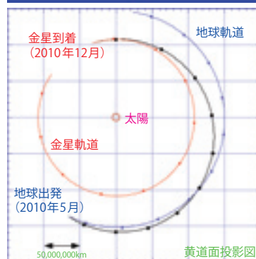
図2 地球出発→金星到着までの軌道(図中黒実線) 地球出発後、一度地球軌道の外側に出て少し時間を稼ぎ、遅れてやって来る金星との接近条件を合わせている。地球出発から金星到着までの飛行日数は約200日。2010年12月初旬に金星周回軌道への軌道制御を行い、本格的な金星観測が始まる。
