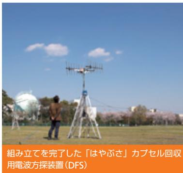
組み立てを完了した「はやぶさ」カプセル回収用電波方探装置(DFS)
