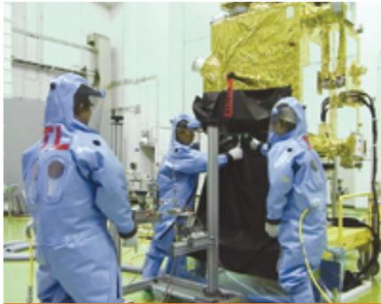
「あかつき」への推薬充填風景。防護服を着用して動きが制約される中、細心の注意を払って作業が実施された。
