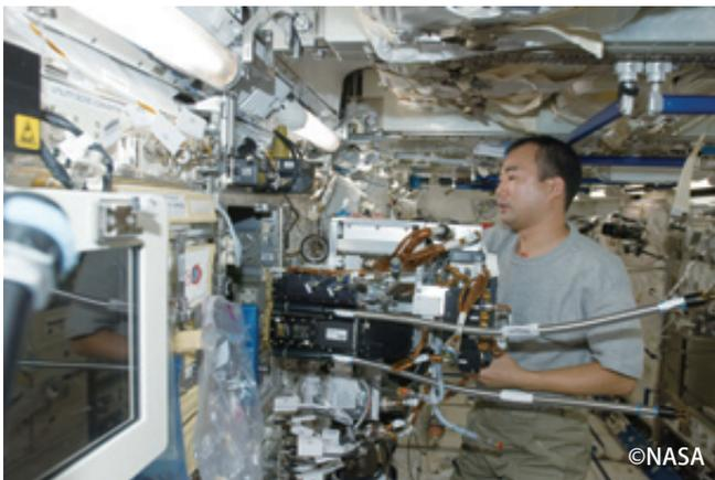
図1 野口宇宙飛行士によりRYUTAIラックから取り外された実験供試体
