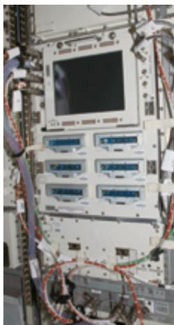
図1 「きぼう」に搭載された画像取得処理装置 (IPU)
