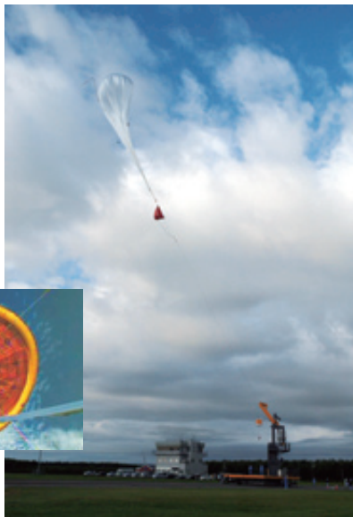
B09-04実験での気球放球と上空で展開したエアロシェル(左)
