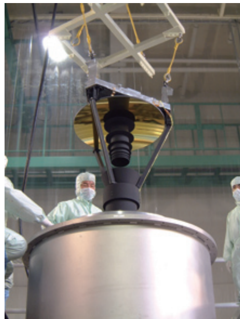
図 28 「あかり」望遠鏡の冷却試験装置での測定風景
