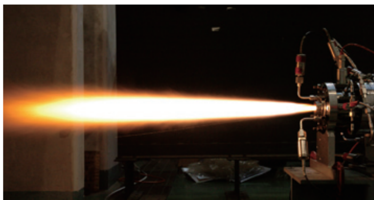
図 2 GAP/酸素ハイブリッドロケット燃焼試験
