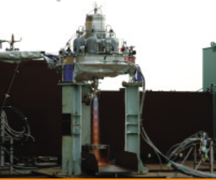
真空推力2 kN級軌道制御エンジンBBMの大気燃焼実験の様子
