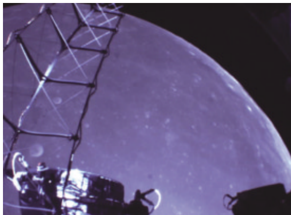
図1 「かぐや」搭載モニターカメラによる伸展マスト(左側)の画像。広角レンズのため曲がって見えるが、実際は12mまで直線的に伸びている。背景は100km下の月面。
