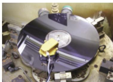
図2 ELID研削加工後のSiCミラーの鏡面
