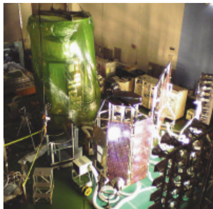
ASTRO-EII衛星照射試験（2004年9月30日、ISAS衛星クリーンルーム）。この試験ではend-to-end試験の一環として、疑似太陽光（写真右下）を太陽電池パドル（写真中央右側）に照射し電力を確保した上で、地上系との有線の接続をすべて切り離し、軌道上動作に近い状態を模擬しました。また、硬X線検出器の感度を上げるため、衛星全体をビニールバッグに入れて（写真左側）温度を周辺よりも数度下げています。また、X線分光器の液体ヘリウムを超流動化するための排気も行いました（写真左下に排気用配管）。
