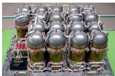
図2 技術試験衛星VIII型（ETS-VIII）用100Ah高圧型ニッケル水素電池の1ユニット。これを二段直列に接続し、1バッテリーを構成する。
