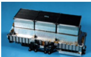
写真1 大面積比例計数管(LAC) 8個搭載。この種の観測器として世界最高感度を持つ。
