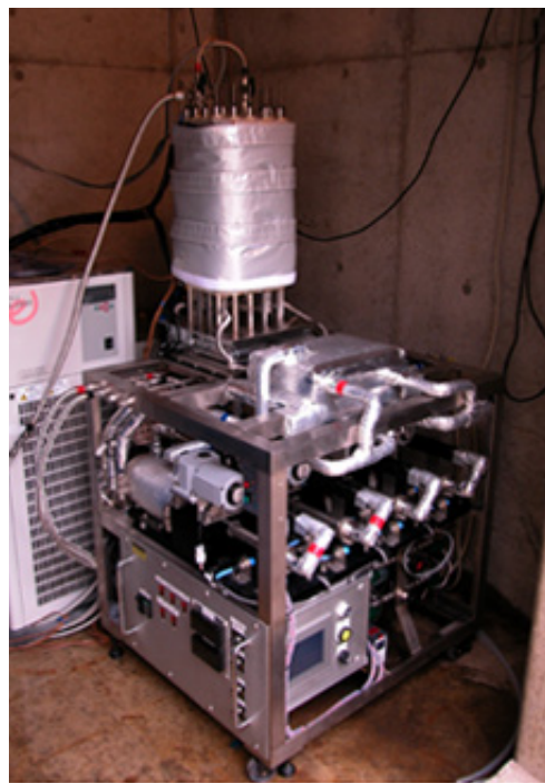
図3 閉鎖運転を目指したJAXA試作燃料電池 スペースシャトル運用模擬を含む1000時間以上の運転試験を実施
